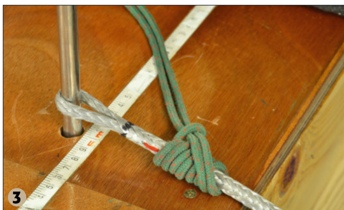
3 ▲ Il repasse l'extrémité nouée de la garcette dans la boucle. Dans cette position, le nœud de Machard peut toujours coulisser sur la tresse.
