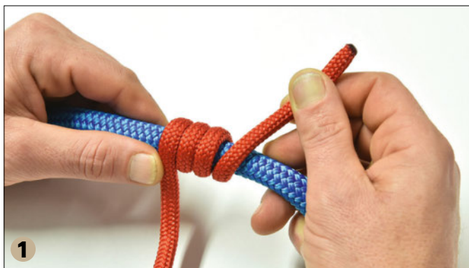
▲ Le nœud de Prussik démarre presque comme le nœud de bosse, avec trois tours morts orientés dans le sens de la traction.
