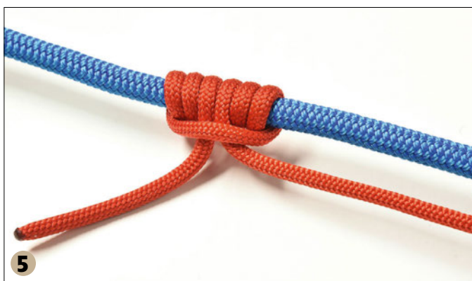
▲ Au moment du serrage, il faut veiller à positionner correctement les tours morts afin que le nœud soit bien équilibré.
