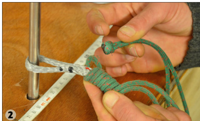
2 ▲ Après avoir fait du matelotage sur un cordage en Dyneema, il faut chasser l'air de la tresse. Julien fait quatre tours morts avec la garcette.
