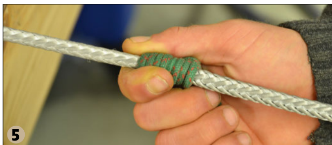
5 ▲ Il gère le serrage du nœud pour obtenir un compromis serrage-glissement qui permet de faire coulisser le nœud et de compacter la tresse.
