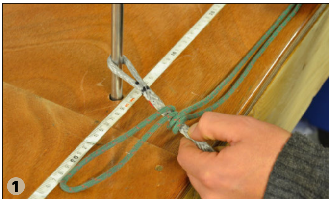
1 ▲ Comme le nœud de Prussik, le nœud de machard est un nœud autobloquant mais qui s'utilise en double (la garcette forme une boucle).
