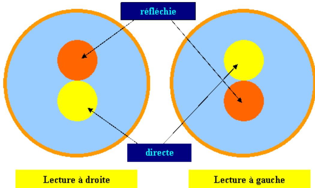
**figure 7 : détermination de la collimation C**
