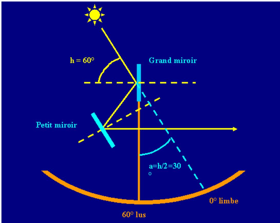
**figure 4 : principe de la graduation du limbe**
