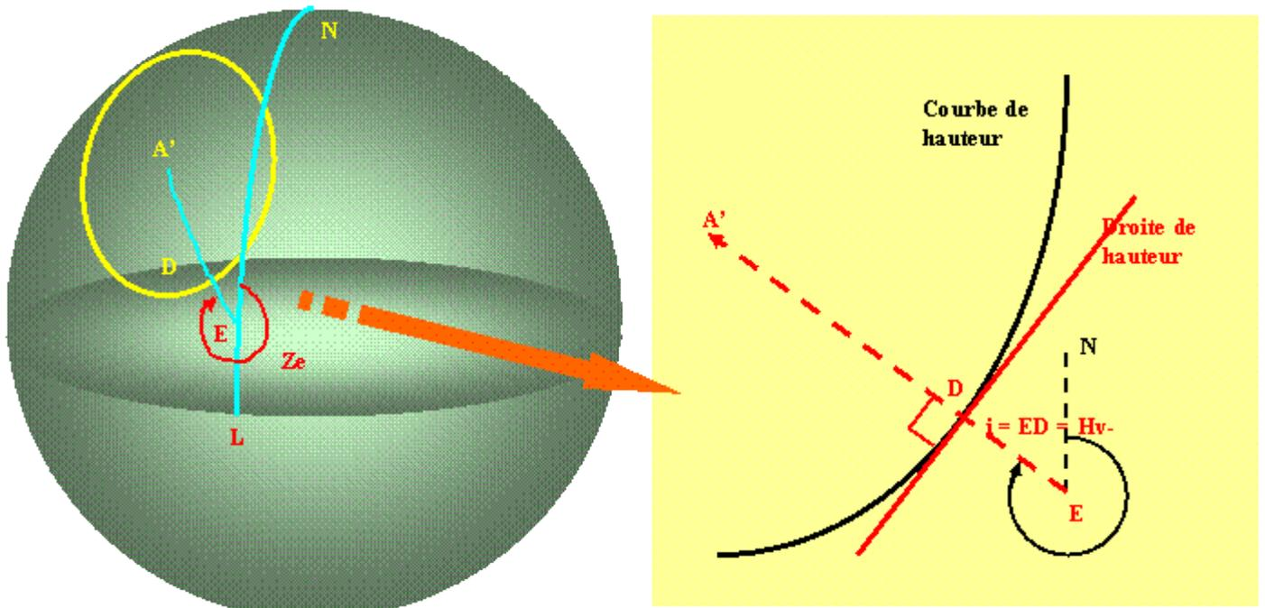
figure 17 : détermination de la droite de hauteur à partir du point d'estime E
