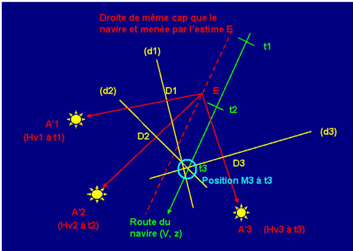
figure 19 : principe du point crépusculaire
