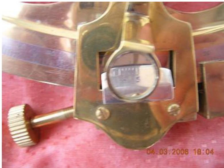
photo 4 (F. Elie) : fenêtre de lecture et sa vis de réglage
